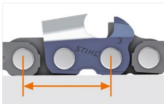
Для определения шага цепи измеряют расстояние между тремя соседними заклепками и делят это значение пополам.
