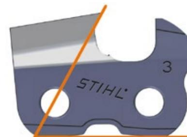
Для ровной, спокойной работы и оптимальной мощности реза пильной цепью все режущие зубья должны иметь одинаковую длину, и должен быть выдержан правильный угол заточки.
