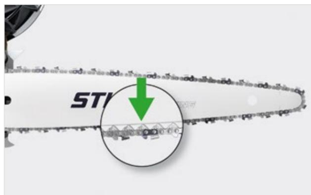
При использовании направляющих шин Carving E пильную цепь следует натягивать несколько слабее. Здесь должна быть видна половина ведущих звеньев на нижней стороне направляющей шины.
