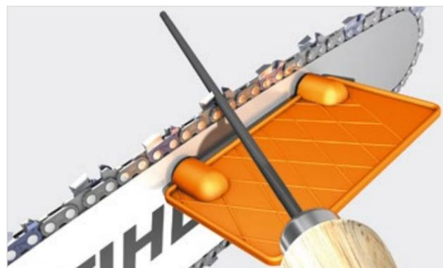
Для получения правильного угла заточки предлагаем использовать указатель направления. Благодаря направляющим линиям выдерживать угол гораздо удобнее. Указатель направления необходимо закрепить на направляющей шине при помощи двух магнитов и можно приступать к работе.
