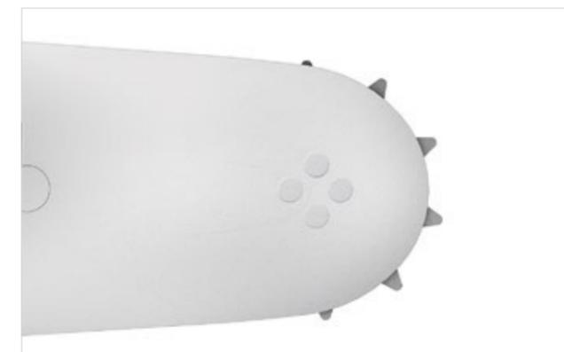
Шаг концевой звездочки шин Rollomatic соотносит ее с определенным шагом пильной цепи и цепной звездочки. Здесь также действует правило, что шаг всех трех компонентов обязательно должен совпадать.
