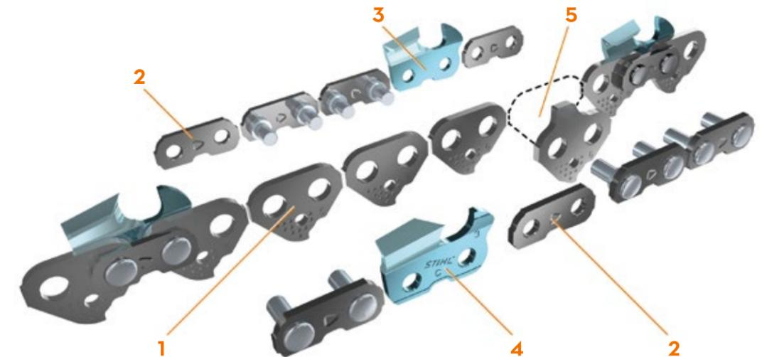
Пильные цепи состоят из ведущих звеньев (1), соединительных звеньев (2), левых режущих зубьев (3) и правых режущих зубьев (4). Пильные цепи с малой отдачей имеют бугорчатые ведущие звенья (5) и обозначаются цифрой 3 в наименовании пильной цепи, например 36 RS3.
