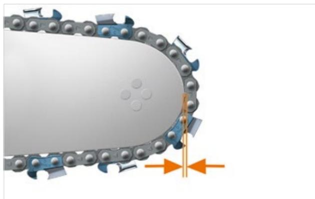
Между пильной цепью и ее вершиной должен быть интервал. Если пильная цепь прилегает к вершине шины, то зубья направляющей звездочки изнашиваются или повреждается подшипник звездочки.
