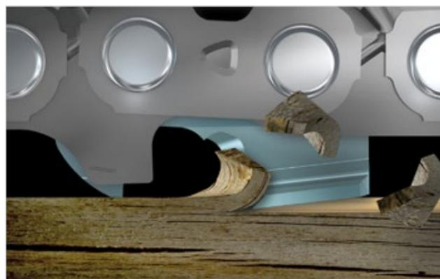
Режущие зубья работают по принципу рубанка. Они строгают стружку из дерева. При этом верхнее лезвие поднимает стружку от основания пропила, в то время как торцевое лезвие отводит стружку в сторону.
