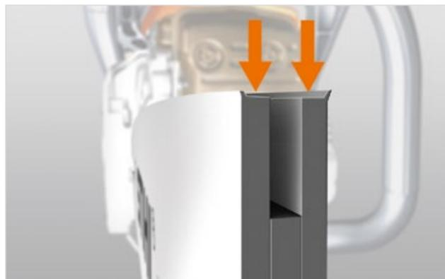
В результате износа стенок пазов шины на их наружных кромках образуются заусенцы.
