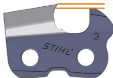
Глубина врезания режущего зуба в дерево и, тем самым, толщина стружки, определяется расстоянием от верхней кромки ограничителя глубины до его лезвия – расстоянием ограничителя глубины.
