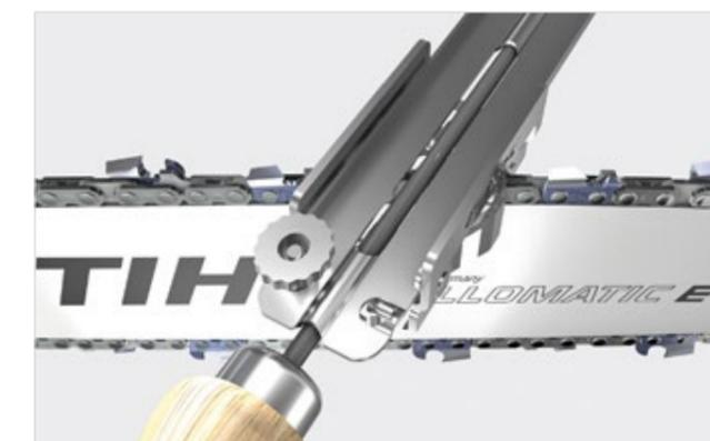
Установите направляющую державки напильника на направляющую шину под углом 30°. Зажимная державка движется по направляющей и благодаря ей соблюдается правильный угол заточки.
