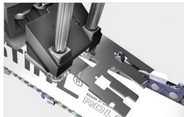
Дополнительно FG 4 имеет откидную пластину для проверки и подточки ограничителей глубины. Контрольная пластина делает возможным два расстояния ограничителя глубины: для твердых и мягких пород дерева.
