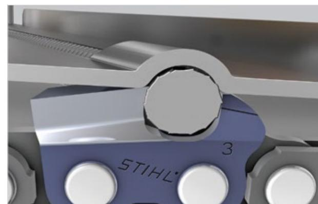
Благодаря правильному наложению зажимной державки STIHL на верхушку зуба и ограничитель глубины, обеспечивается движение напильника на правильной высоте и получается правильный торцевой угол. Благодаря видимой маркировке 30° зажимная державка также помогает получать правильный угол заточки.
