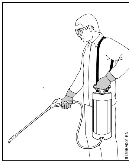
Агрегат с помощью подвесного ремня повесить на левое плечо. Подвесной ремень не носить крест-накрест, чтобы в случае необходимости агрегат можно было быстро снять.
