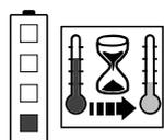
Akumulátor je príliš teplý. Nabíjanie sa začne po ochladení akumulátora, resp. akumulátor sa dá používať až po ochladení.
