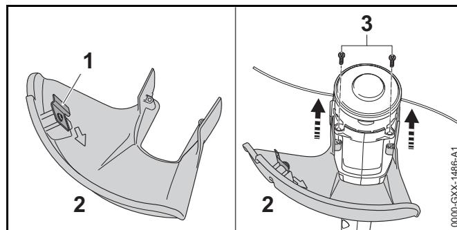
Отрезной нож (1) уже установлен в защиту (2) и его нельзя снимать.
