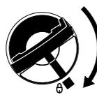
Правильно установить крышку бака с откидным хомутиком (байонетный затвор), повернуть до упора и захлопнуть хомутик.
