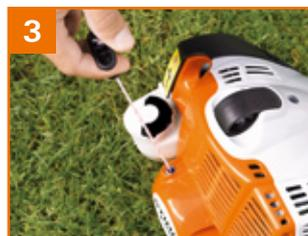
3 После нескольких пусковых движений двигатель запускается, и инструмент начинает работать. После нажатия рычага газа рычаг дроссельной заслонки автоматически вернётся в исходное положение.
