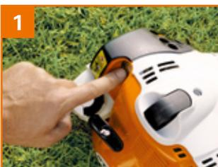
1 Подкачайте топливо топливным насосом (5 нажатий).
