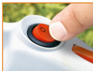
Постоянная готовность к работе: непродолжительное нажатие кнопки останова немедленно останавливает инструмент. При этом происходит автоматическая активизация зажигания, за счет чего обеспечивается постоянная готовность двигателя к повторному запуску.
