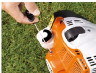
Устройство для плавного и комфортного запуска двигателя благодаря дополнительной пружине между коленвалом и катушкой пускового тросика. Для надёжного запуска мотокос с пусковым устройством ErgoStart достаточно одного плавного движения с захватом двумя пальцами. Входит в серийное оснащение всех моделей с обозначением C-E.
