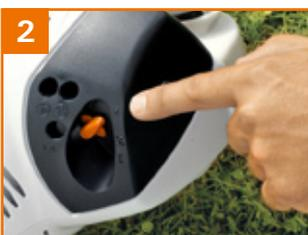
2 Отрегулируйте позицию дросселя с помощью рычага дроссельной заслонки (регулировка зависит от вида запуска – «холодного» или «горячего»).
