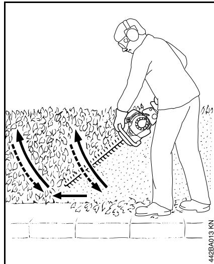
Мотоножницы вести дугообразно снизу вверх – опустить вниз и продолжать двигаться дальше – мотоножницы вести снова дугообразно вверх.
